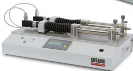
Doppel-Druck-Volumen-Steuerung mit zwei unabhängigen Kanälen bis zu 300 bar
