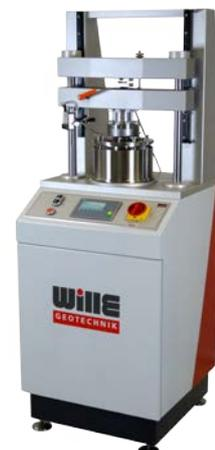
Statisches und dynamisches Ringschergerät
