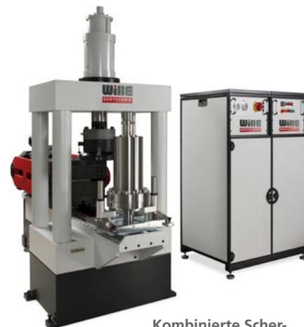
Kombinierte Scher- und Triaxial-Prüfanlage
