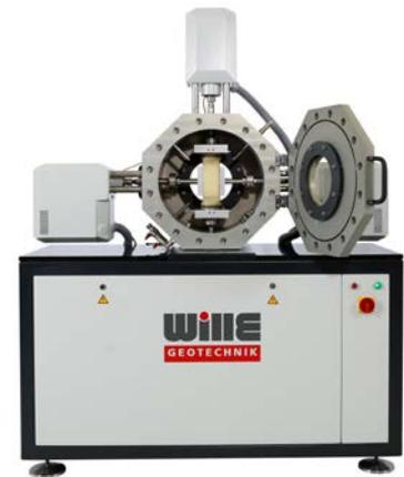
Temperiertes True Triaxial Prüfsystem
