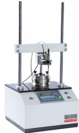
Elektromechanisches Kompressionsgerät (Tischgerät)
