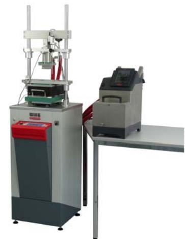
Temperiertes Direkt- und Simple Schergerät (DSS)
